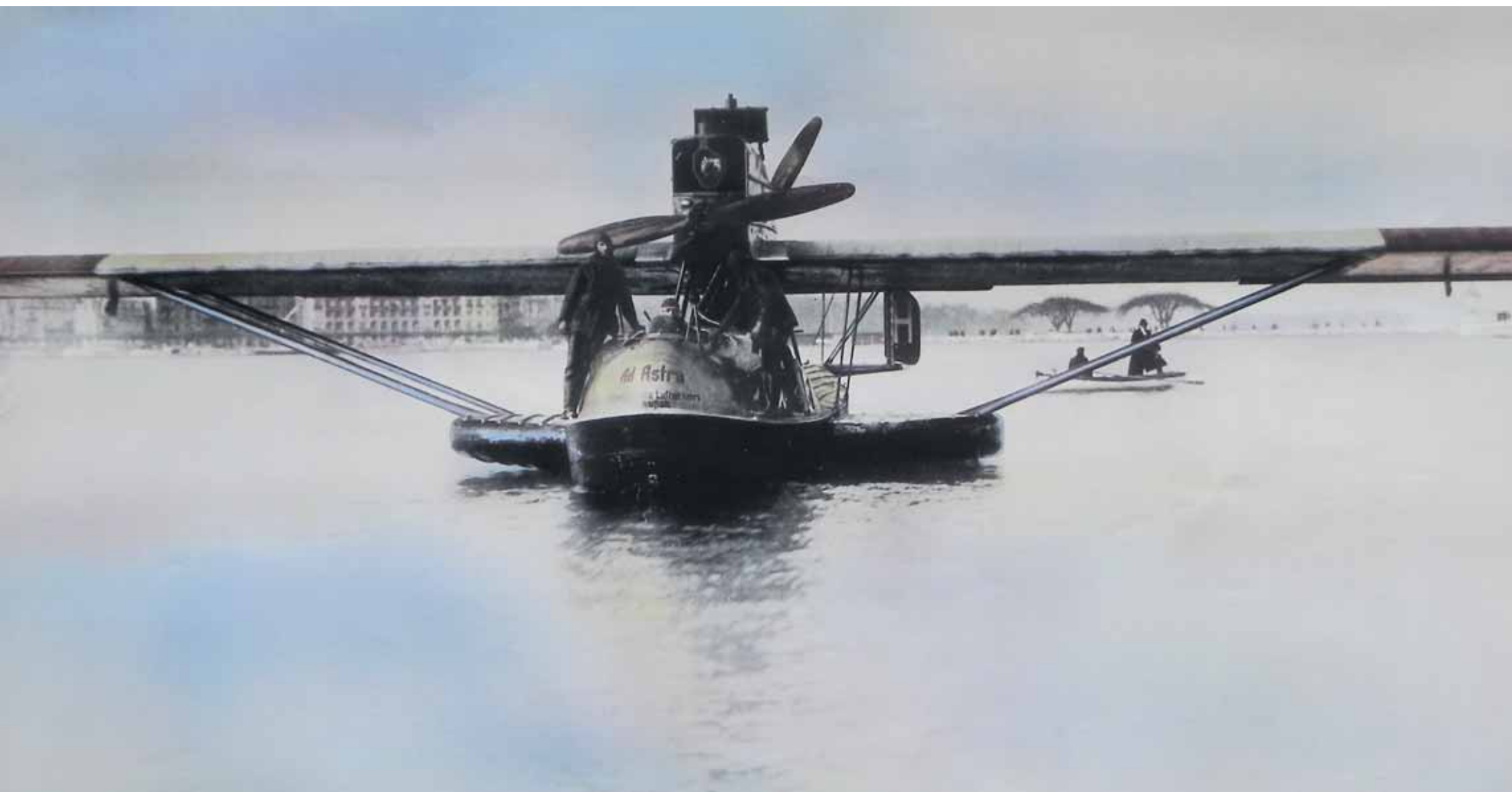
Hydravion Dornier «Wal» d'Ad Astra Aero, avec deux moteurs Hispano-Suiza de 1100 cv, 8-10 places, 140 km/h, 4750 kg, à Genève en novembre 1919 (Calendrier Swissair 1990)
